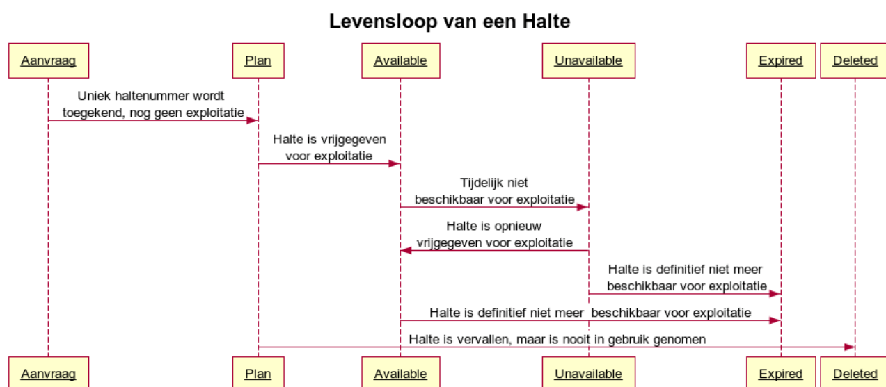
Figuur 4 Statusovergangen van een Quay
